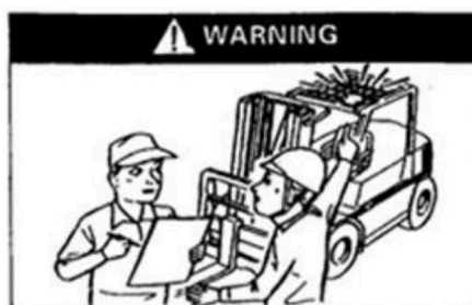
Ne pas utiliser le chariot élévateur s'il est endommagé ou en panne.
