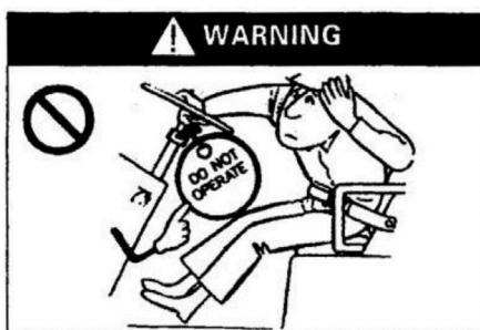
Ne pas utiliser le chariot élévateur s'il présente des défaillances.
