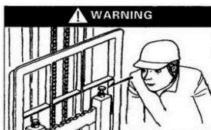
Vérifier que l'axe de verrouillage des fourches est correctement fixé.
