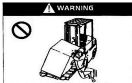
Ne pas utiliser de palettes endommagées.
