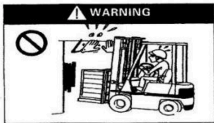
Vérifier systématiquement la hauteur libre dans la zone de travail.
