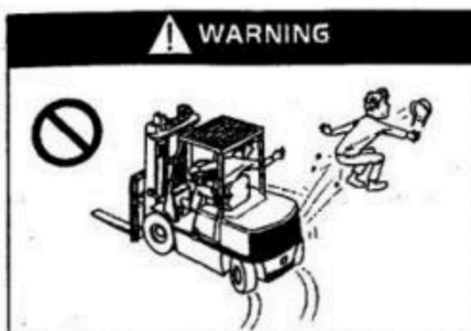
Maintenir une distance de sécurité avec le contrepoids lors des virages.
