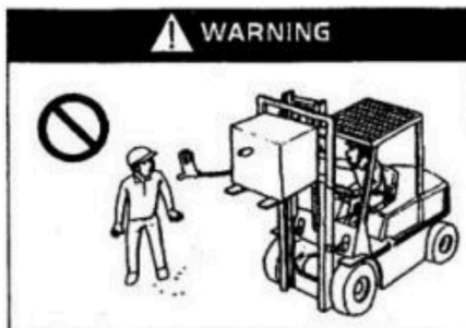
Ne pas autoriser la présence de personnes à proximité du chariot élévateur pendant son fonctionnement.
